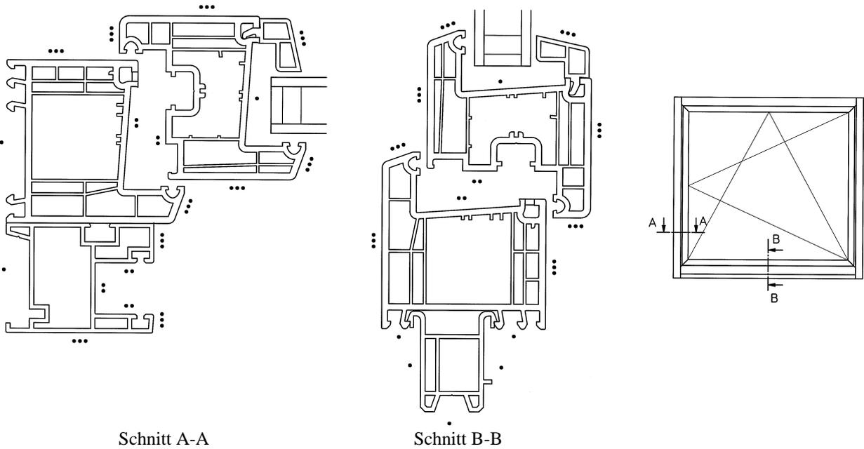
**Bild 1:** Kunststofffenster mit Rollladenführung und unterer Anschlusschiene
